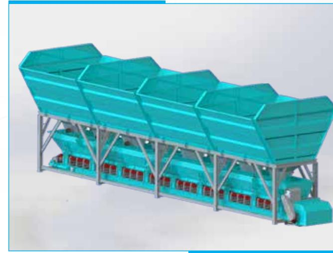
AGREGA STOK BUNKERLERİ / AGGREGATE STOCK BUNKERS
